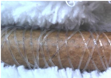
Abbildung 18: Lichtwellenleiter mit wilder Wicklung und Fadenbremse
