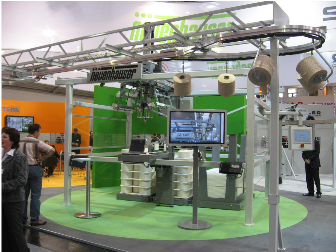
Bild: Messestand, Transport- und Palletieranlage für Naturfaserspulen
