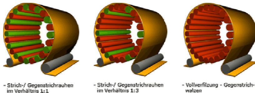
Abb. 14: Walzenanordnung beim „Optisystem XR24/XR30/XR36“ - Rauhen
