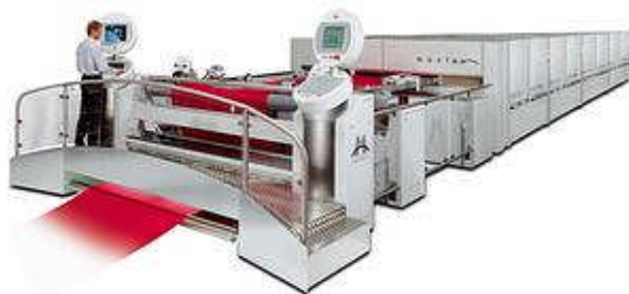
Abb.8: Spannrahmen mit beweglichem Bedientisch
