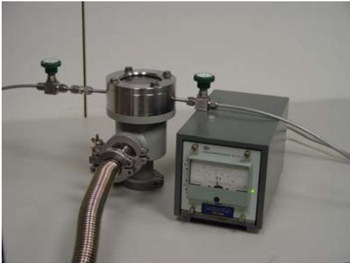
**Abbildung 2.5:** Vakuummkammer mit Druckmessgerät
